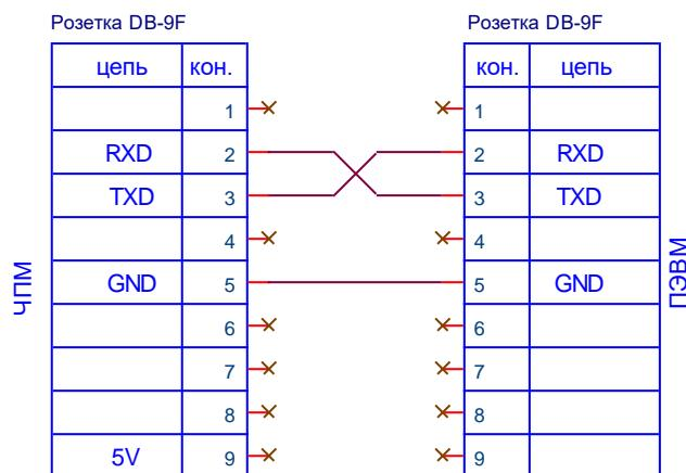
Схема подключения сканера.
